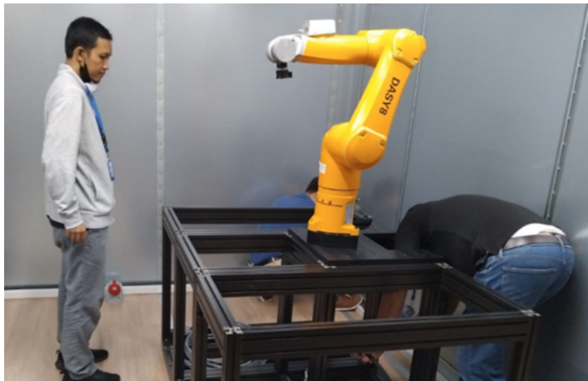
Gambar 3.24 Proses Reinstall Lengan Robot dan Kelengkapannya
